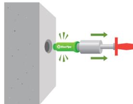
2. Mit der Hilfe des RiveOut wird das RivePipe auf beiden Seiten der Mauer entnommen.
