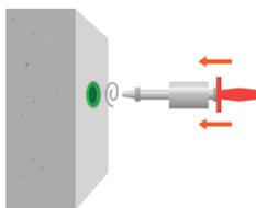
1. Nach Ausschalung der Mauer wird die RiveOut in das RivePipe eingedreht.
