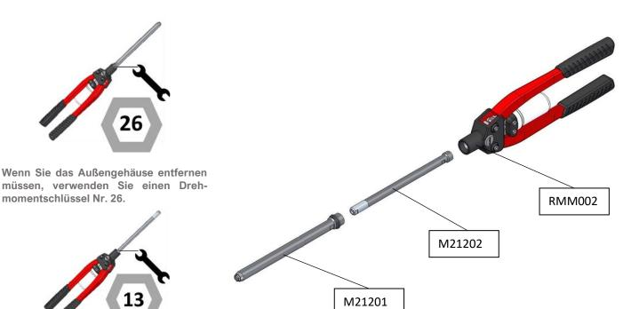
Wenn Sie die innere Zugstange entfernen müssen, verwenden Sie einen Drehmomentschlüssel Nr 13.
