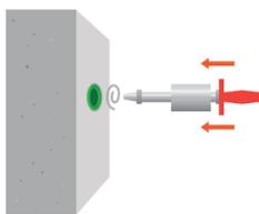
1. Una vez desencofrado el muro se inserta RiveOut dentro del RivePipe.
