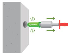
2. Con ayuda del RiveOut, se extrae el RivePipe de los dos lados del muro.
